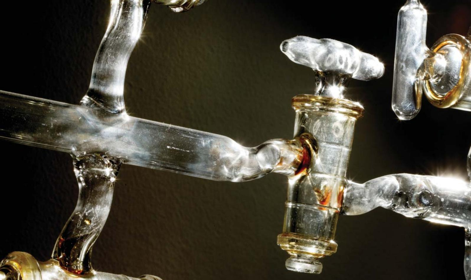
🔗 *Tubería bajo vacío utilizada antiguamente para la síntesis en fase gaseosa. Pieza de la colección histórica de la Universidad de Copenhague (Dinamarca).*
